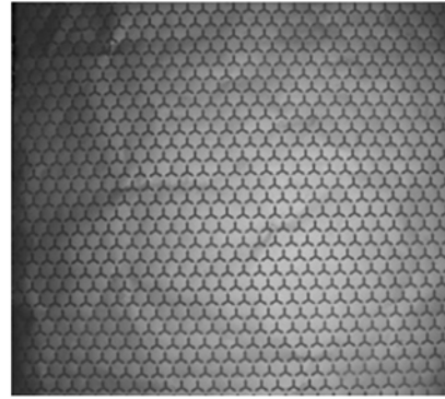
图 9 二阶 Y 孔测试样件 Fig. 9 Sample of FSS screen
